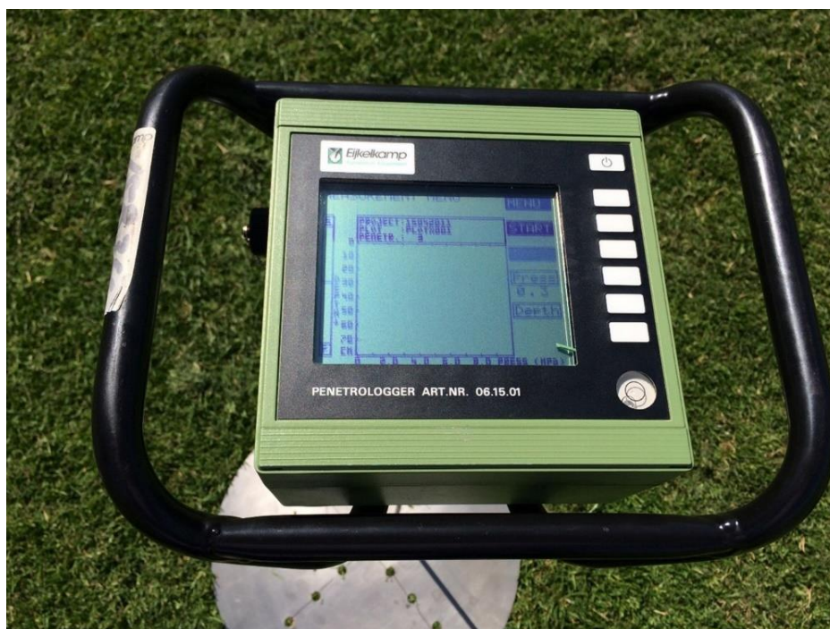
Slika 11. Elektronski konusni penetrometar „Penetrologger ART.NR.06.15.01“ Eijkelkamp (Izvor: https://www.rasenplan.com/expertisen/ )
