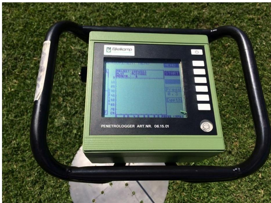
Slika 11. Elektronski konusni penetrometar „Penetrologger ART.NR.06.15.01“ Eijkelkamp
