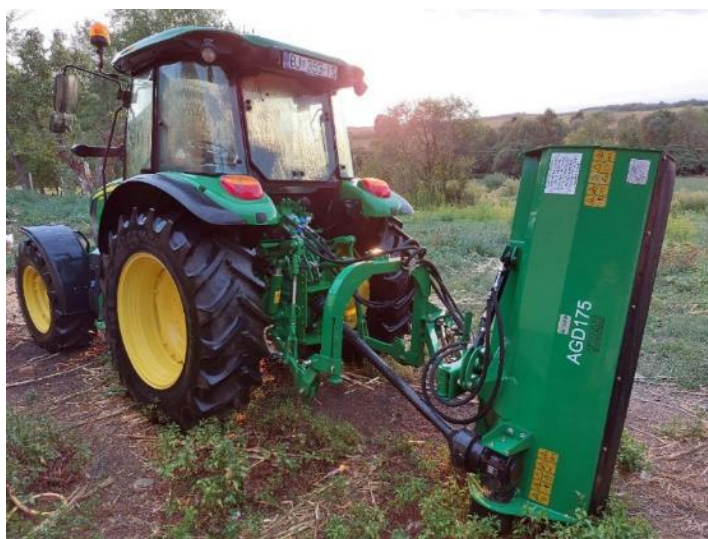
Slika 21. Mehanizacija za mehaničko uništavanje korova (Autor: Branko Pucarín)
