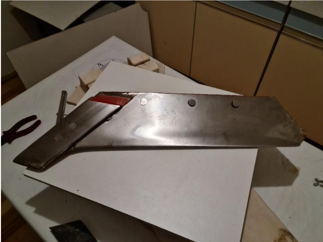
Slika 4. Korišteni lemeš s okretnim dlijetom
