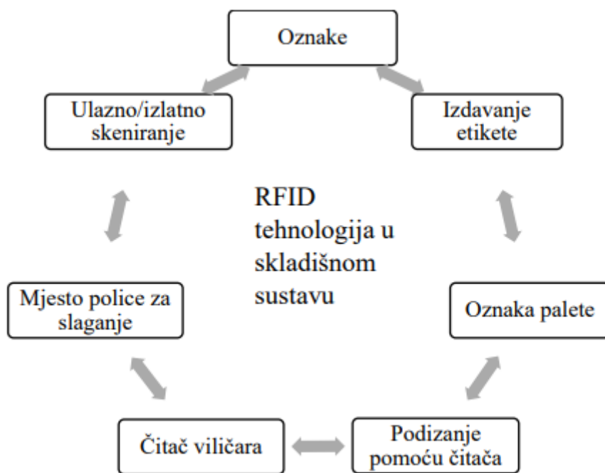
Slika 28. RFID tehnologija u skladišnom sustavu
