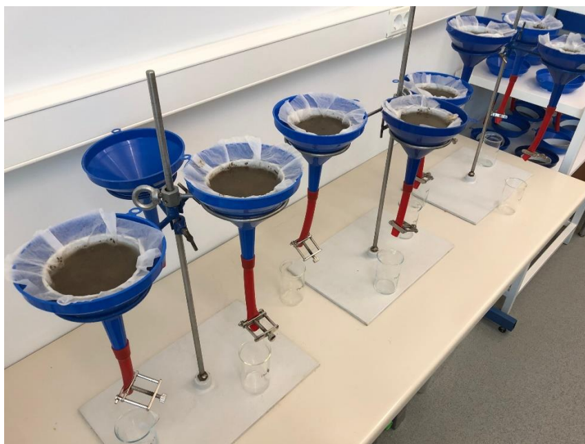
Slika 4. Izdvajanje nematoda iz tla Baermanovom metodom ljevaka (Rajndl, 2022.)
