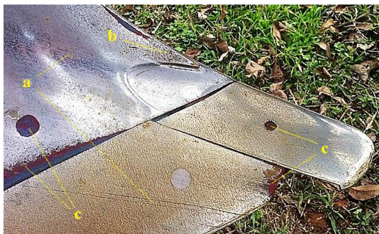
Slika 12. Tragovi trošenja alata za obradu tla (Izvor: Ausec, 2017.)
