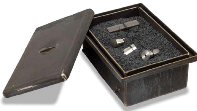
Slika 9. Kutija za boriranje s proizvodima u granulatu (Izvor: Nabertherm, 2007.)
