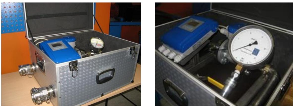
Slika 9. Elektromagnetni mjerač kapaciteta tvrtke „Khrone“
