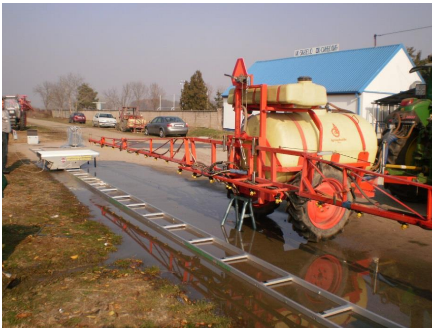
Slika 13. Ispitivanje horizontalne raspodjele - spray scanner
