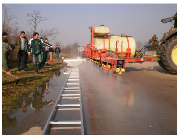
Slika 12. Uređaj za ispitivanje horizontalne raspodjele tekućine – spray scanner
