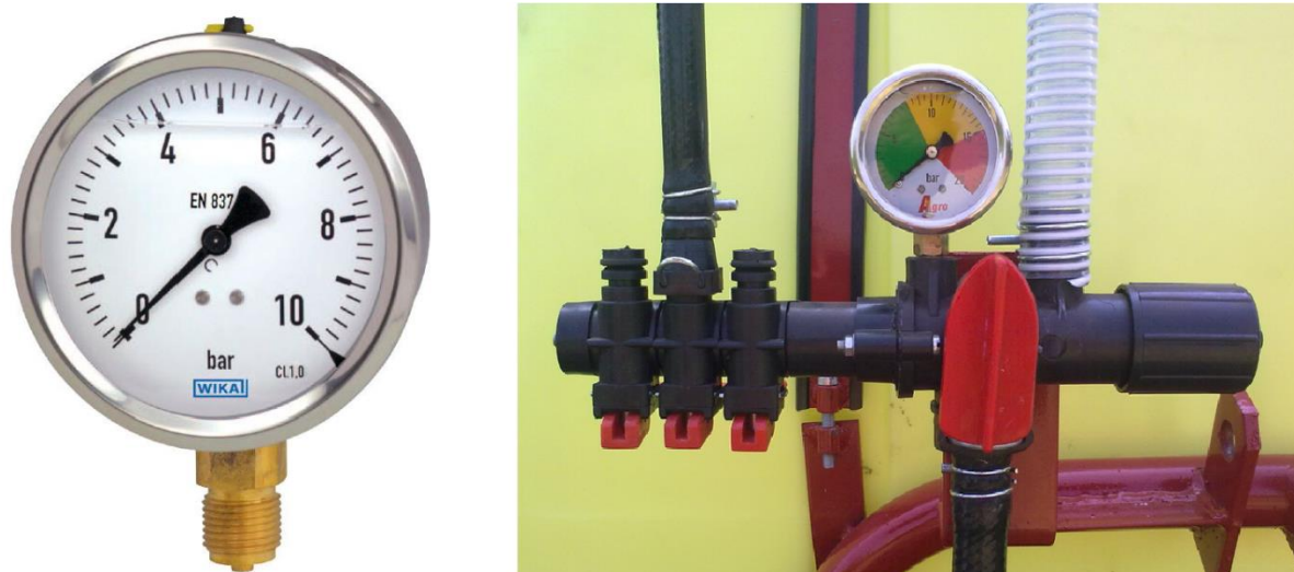
Slika 6. Regulator tlaka (desno); manometar (lijevo)
