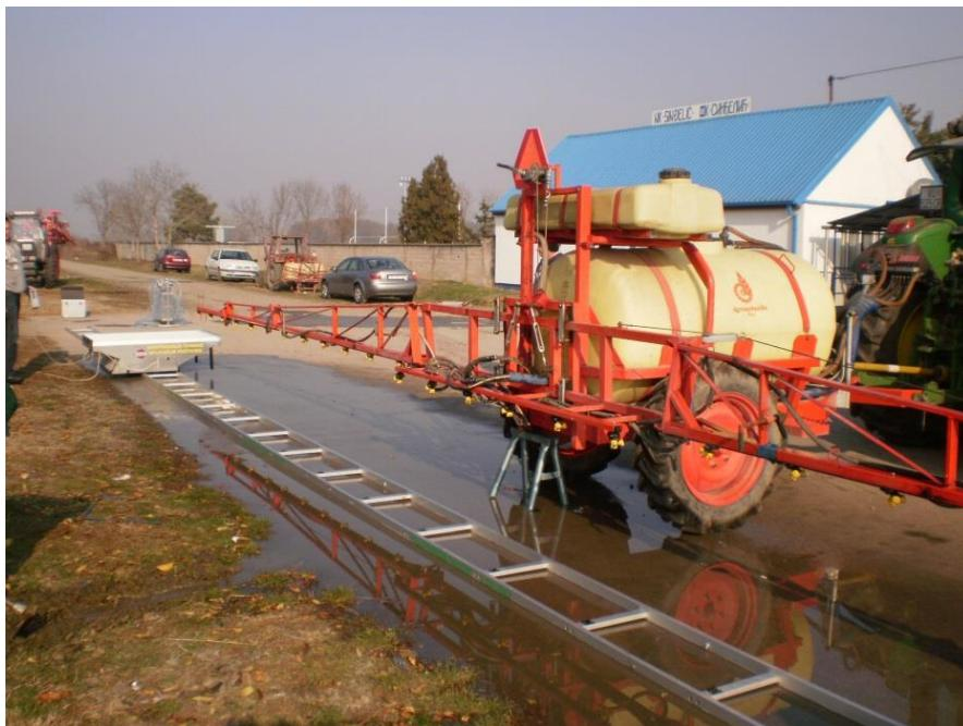
Slika 13. Ispitivanje horizontalne raspodjele - *spray scanner*
