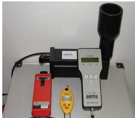
Slika 11. Stolno – elektronski uređaj za mjerenje protoka mlaznica (lijevo) i uređaj za mjerenje protoka AAMS (desno)
