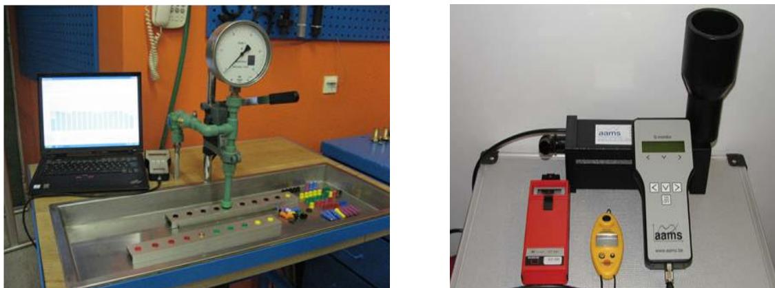
Slika 11. Stolno – elektronski uređaj za mjerjenje protoka mlaznica (lijevo) i uređaj za mjerjenje protoka AAMS (desno)
