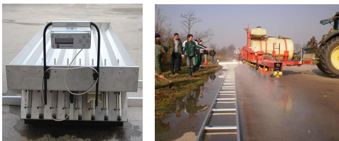
Slika 12. Uređaj za ispitivanje horizontalne raspodjele tekućine – *spray scanner*
