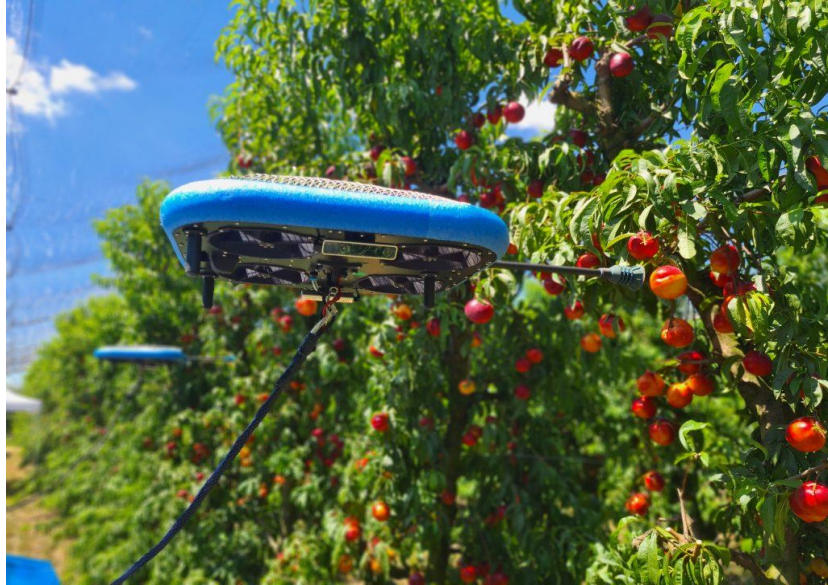
Slika 21. Dron za berbu - Tevel (Izvor: https://www.tevel-tech.com/ )
