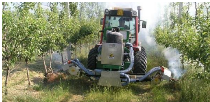
Slika 9. Uništavanje korova plamenom (Izvor: https://www.pakiranje.net/poljoprivredna-mehanizacija/unistavanje-korova-plamenom/ )
