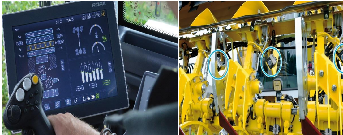
Slika 26. Ultrazvučni senzori koji bilježe konturu tla (Izvor: https://www.ropa-maschinenbau.de/en/products/beet-harvesters/panther-2s/roden-technik/ )
