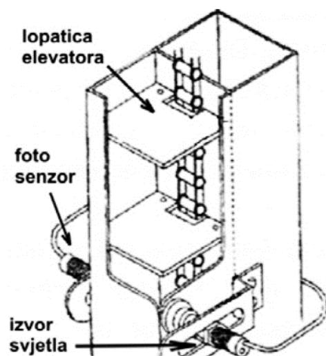
Slika 24. Princip mjerena obujma
