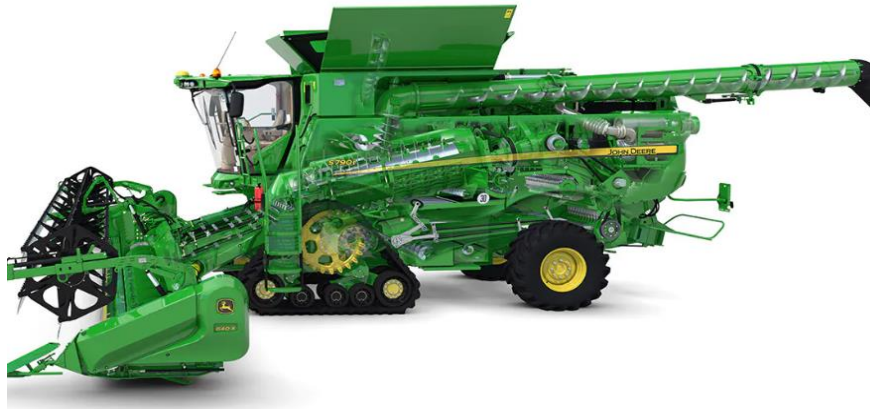
Slika 7. Prikaz pužnih transportera na kombajnu John Deere S 780
