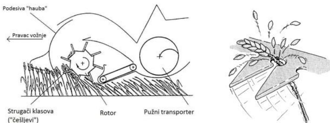
Slika 17. Silsoe stripper-heder (lijevo) s principom rada (desno)
