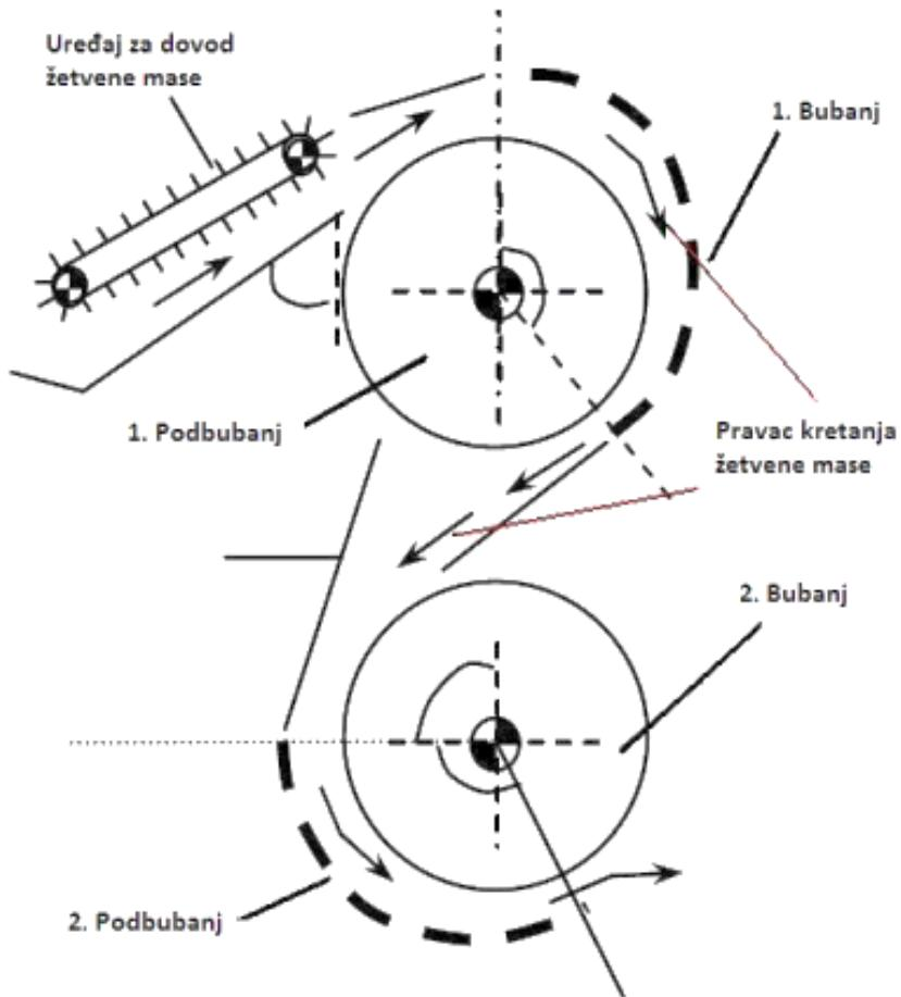
Slika 18. Shematski prikaz novo razvijenog tipa tangencijalne vršalice s dva bubenja
