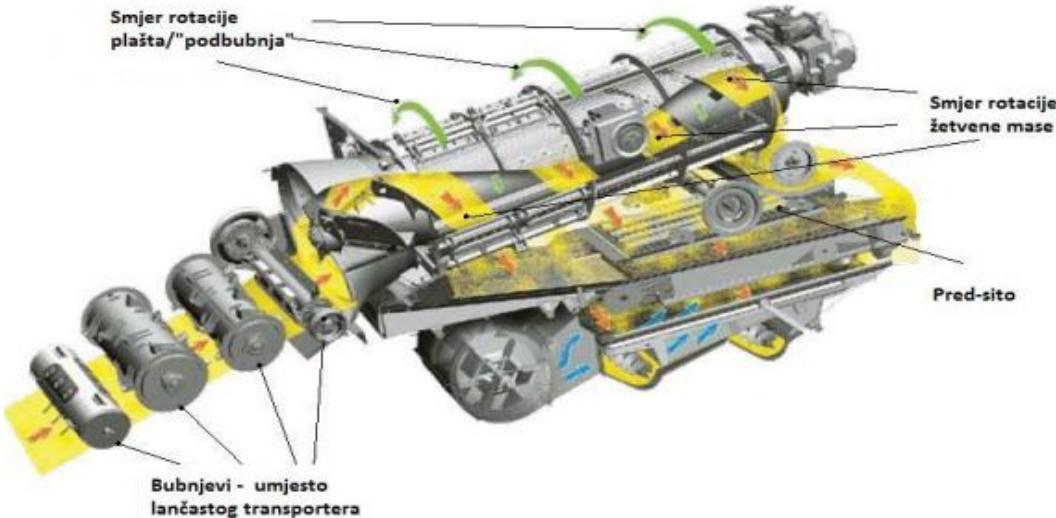
Slika 19. Aksijalna vršalica s rotirajućim plaštem tvrtke *Versatile*
