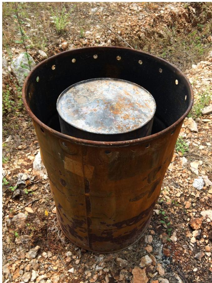
Slika 14. Prikaz peći kućne izrade za proizvodnju biougljena
