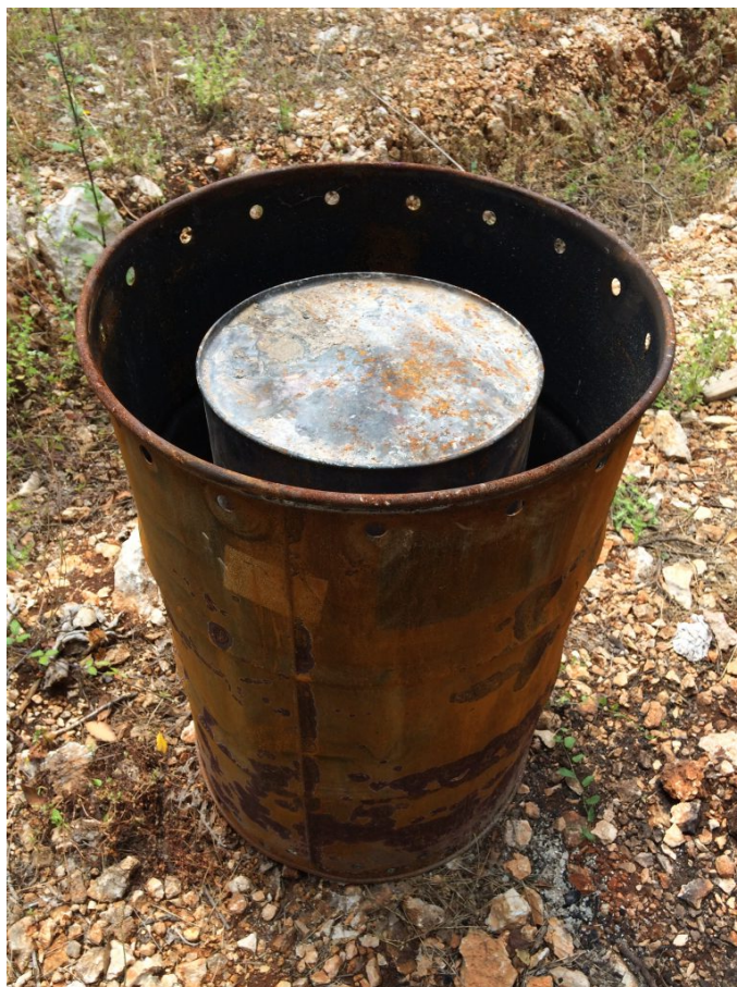
Slika 14. Prikaz peći kućne izrade za proizvodnju biogljjena (Izvor: perforum.info, 2022.).
