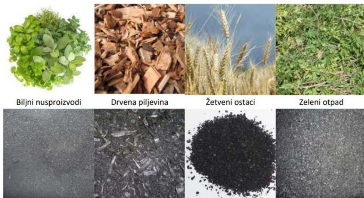
Slika 5. Prikaz svojstava i izgleda biougljena kroz različite biomase korištene za njegovo dobivanje
