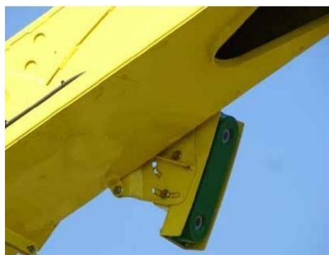
Slika 20. Kamera na utovarnoj cijevi (Izvor: Rihter, 2020.)
