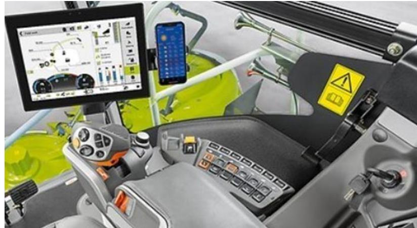
Slika 30. Kabina silažnog kombajna Claas Jaguar 970 (Izvor :
