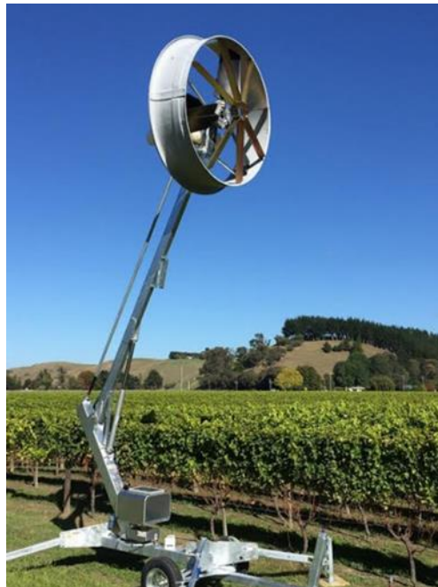
Slika 14. Ventilatori za zaštitu od proljetnog mraza
