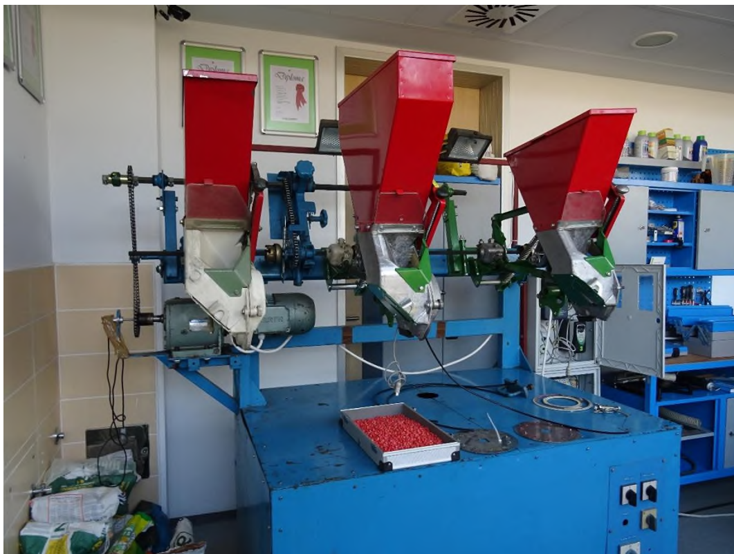
Slika 11. Sjetvene sekcije PSK OLT sijačice na ispitnom stolu u Centralnom laboratoriju za poljoprivrednu tehniku i obnovljive izvore energije
