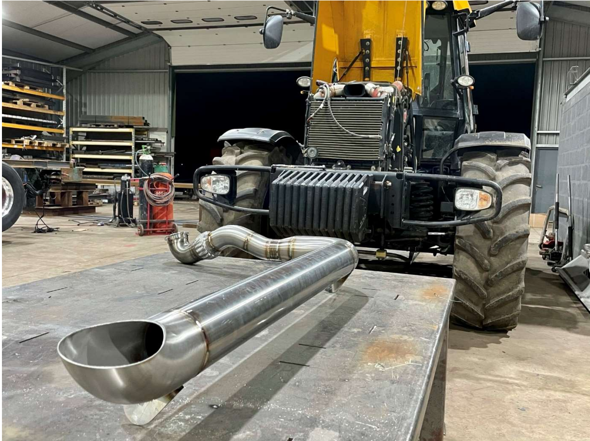
Slika 29. Ispušna cijev na traktoru (Izvor: https://www.mochofabrication.co.uk )
