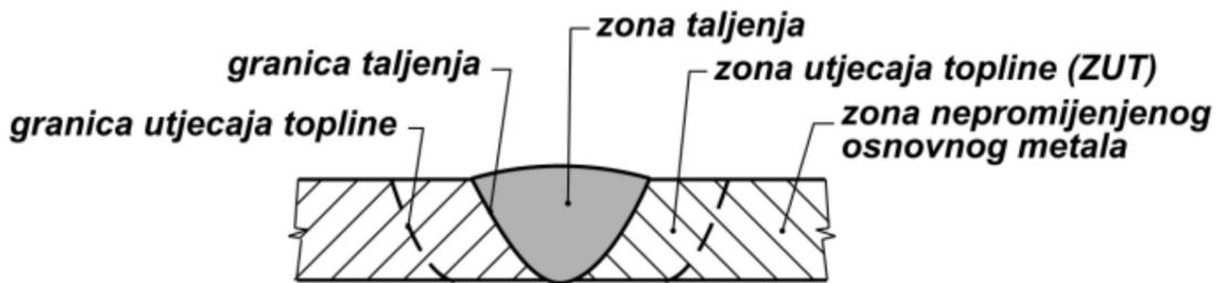
Slika 14. Struktura zavarenog spoja
