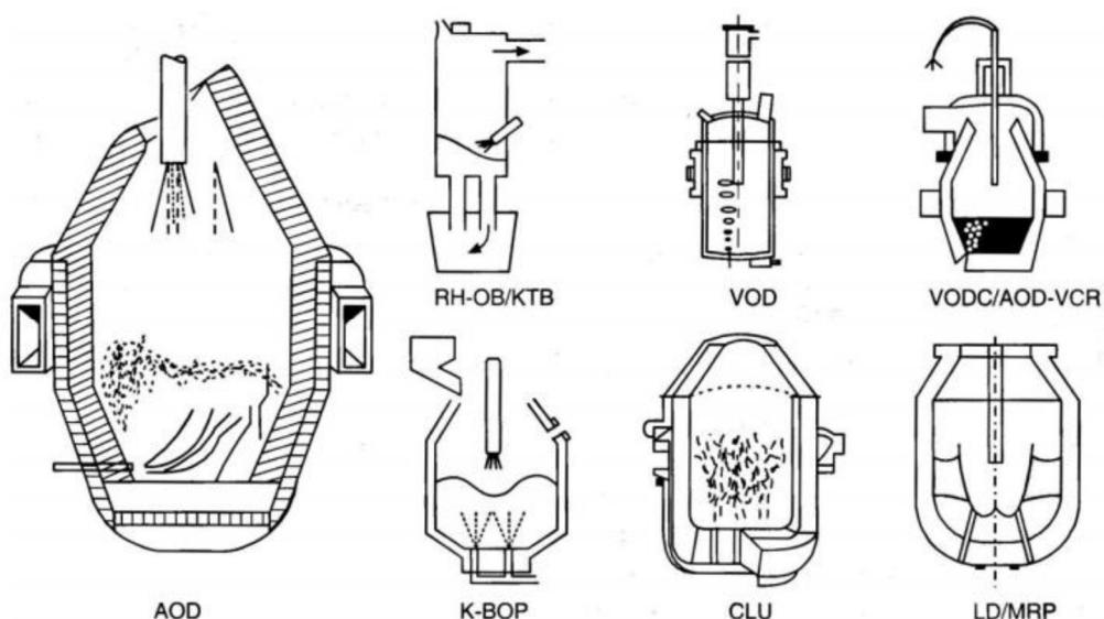
Slika 5. Shematski prikaz postupaka za proizvodnju korozijski postojanih čelika
