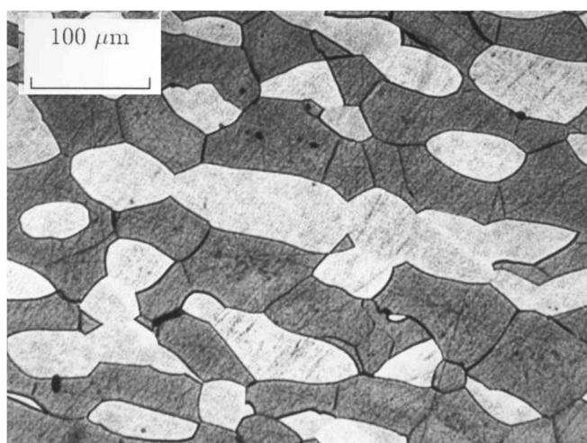
Slika 4. Mikrostruktura dupleks nehrđajućeg čelika
