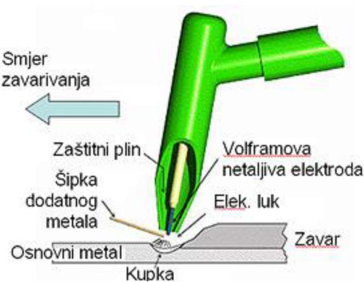
Slika 12. Zavarivanje TIG postupkom
