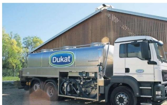
Slika 26. Autocisterna sa spremnikom od nehrđajućeg čelika
