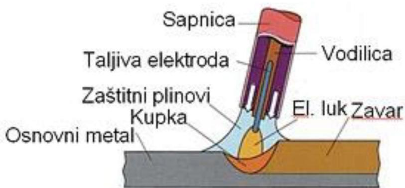
Slika 8. Shema postupka MIG/MAG zavarivanja
