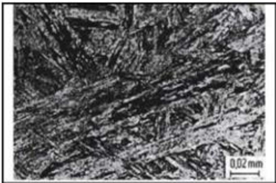
Slika 1. Mikrostruktura martenzitnog nehrđajućeg čelika
