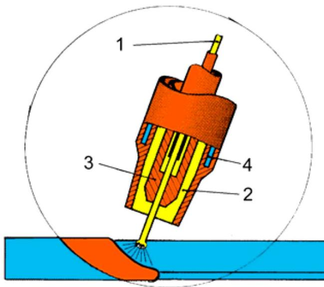
Slika 10. Vrh pištolja za MIG/MAG postupak zavarivanja
