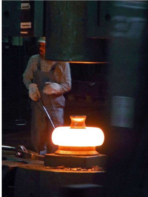
Slika 16. Postupak kovanja u toplom stanju (Izvor: https://www.wikiwand.com/hr/Kovanje )
