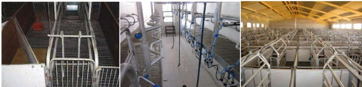
Slika 20. Ograde, kapije i pregrade od nehrđajućeg čelika
