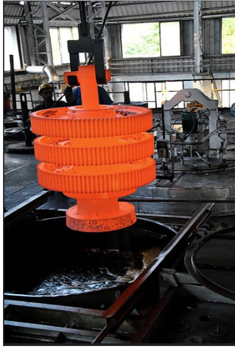
Slika 23. Kaljenje zupčanika u uljnoj kupci ( Izvor: https://www.flickr.com/photos/9982286@N03/sets/72157626453967468/ )
