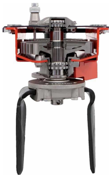
Slika 9. Sustav zupčanika kod rotodrljače (Izvor:
