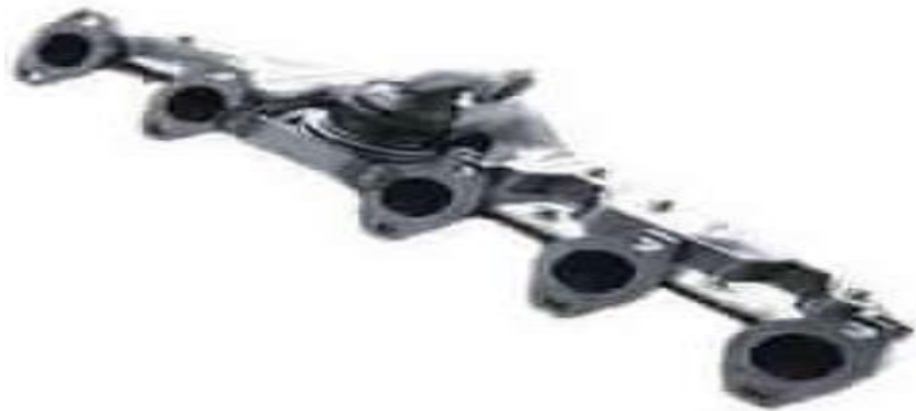
Slika 15. Ispušna grana i ispušni sustav
