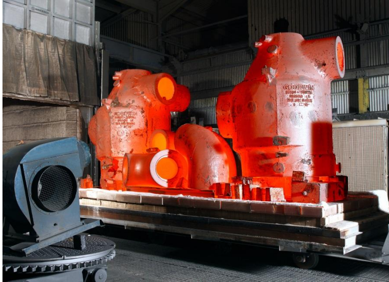
Slika 3. Toplinska obrada žarenja (Izvor: https://hr.wikipedia.org/wiki/Žarenje )
