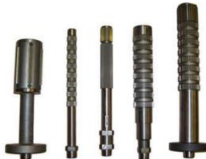
Slika 21. Dugačke igle (vučeni alati) (Slade, 2004.)
