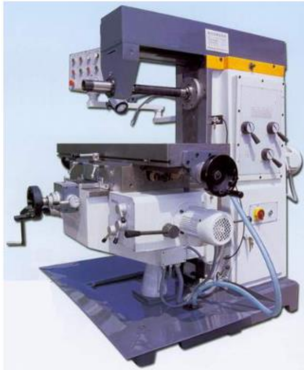
Slika 17. Univerzalna glodalica (Izvor: Slade, 2004.)
