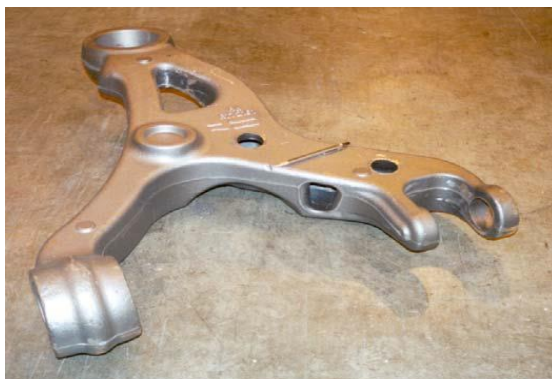
Slika 11. Dio ovjesa traktora John Deere izrađen od nodularnog lijeva
