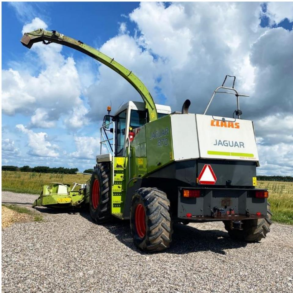
Slika 21. Istovarna cijev kombajna
