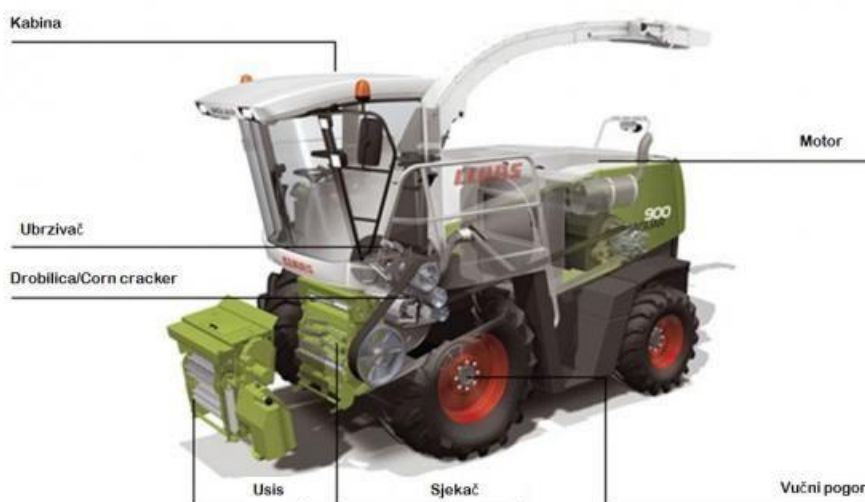
Slika 24. Shematski prikaz silažnog kombajna “Claas Jaguar”
