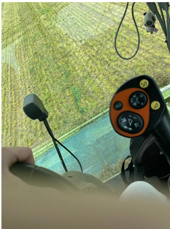
Slika 22. Komandna ručica u silo kombajnu “Claas Jaguar 870 tier IV”
