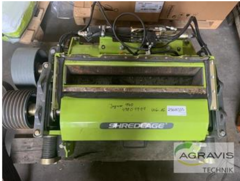
Slika 25 – Usitnjivač mase “corn cracker”
