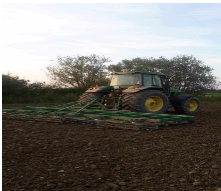
Slika 13. Teška drljača Pecka 4,80m (Izvor: Autor)
