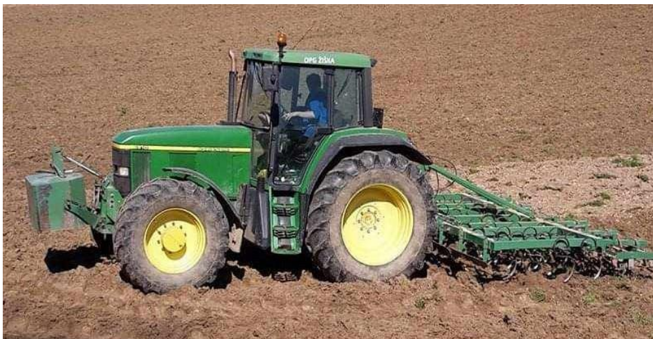
Slika 14. Sjetvospremač Pecka 4,20m (Izvor: Autor)
