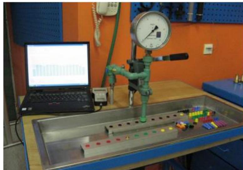
Slika 7: Stolno-elektronski uređaj za ispitivanje mlaznica
