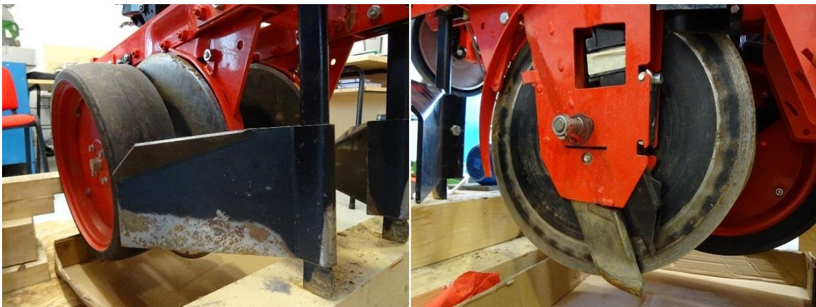
Slika 9. Uređaj za otklanjanje gruda tla u pravcu sjetve (lijevo)
