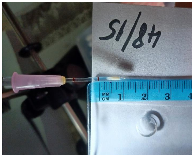
Slika 22. Mjerenje količine sjemena u centimetrima
