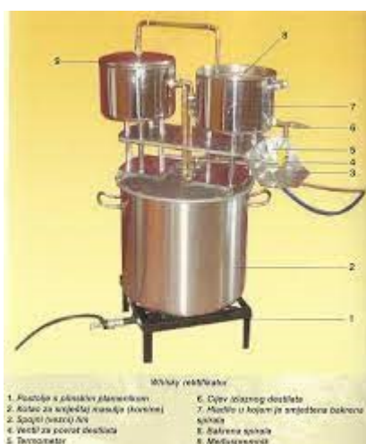
Slika 7. Whisky rektifikator (izvor: https://issuu.com/zokspile/docs/rakija/31 )
