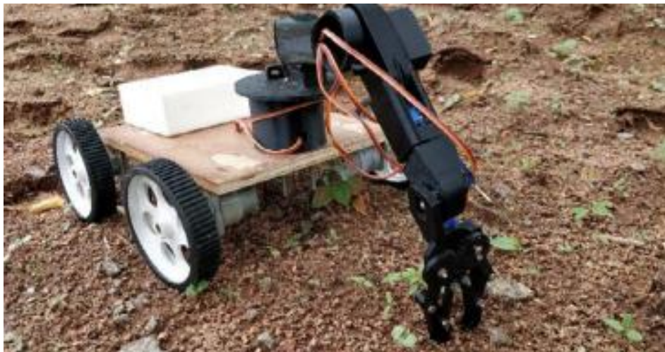
Slika 5. Testiranje robota na polju (sjetva sjemena u tlo)
