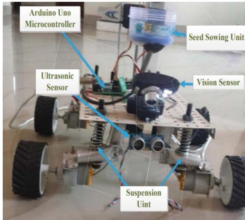
Slika 13. Dijelovi robota za kontrolu i senzori
