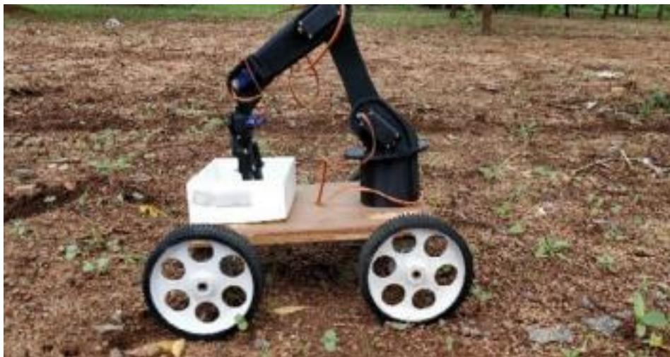
Slika 4. Testiranje robota na polju (uzimanje sjemena)
