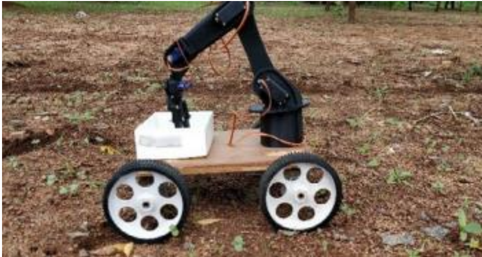
Slika 4. Testiranje robota na polju (uzimanje sjemena)
