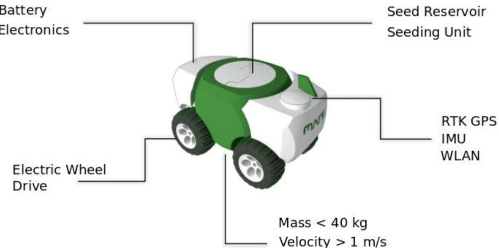
Slika 22. Relevantni podaci o robotu
