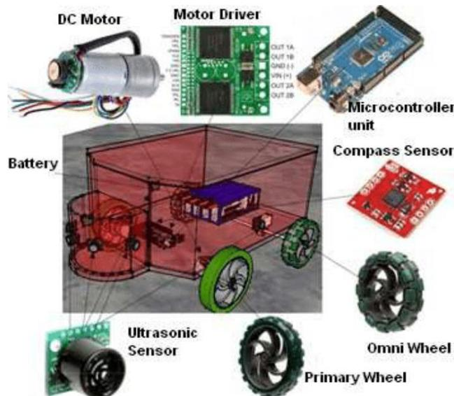
Slika 12. Robot kontroliran Arduinom te njegovi dijelovi za kretanje
