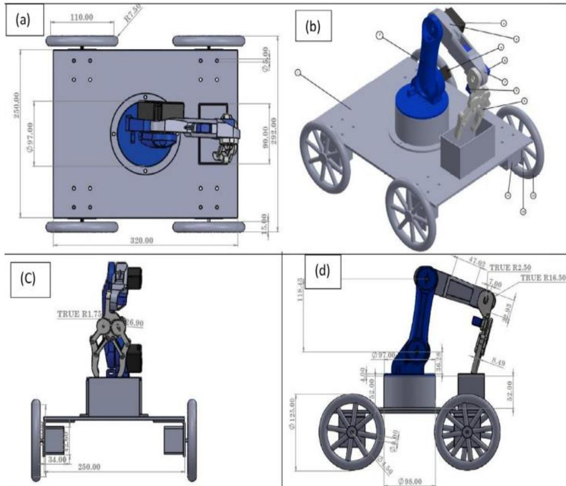
Slika 3. Trodimenzionalni prikaz robota sa mjerama u Auto-CAD-u
