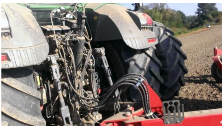
Slika 19. Prikopčavanje traktora i sijačice
