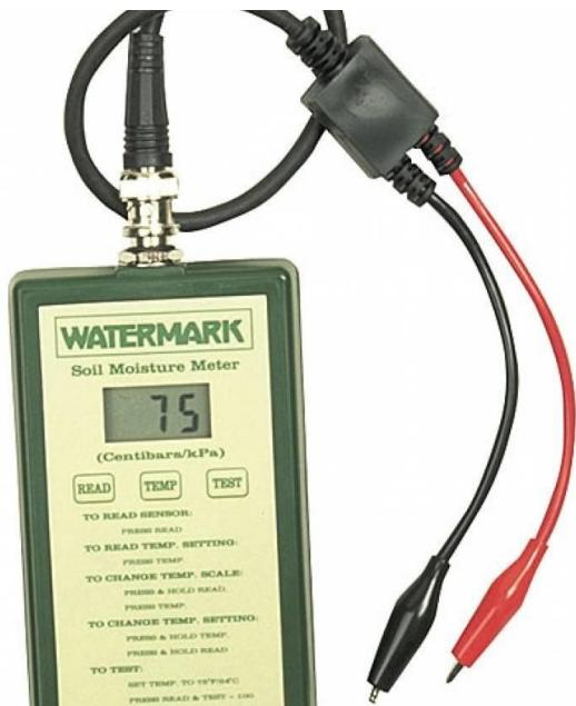
Slika 6. Digitalni uređaj za mjerjenje vlage
