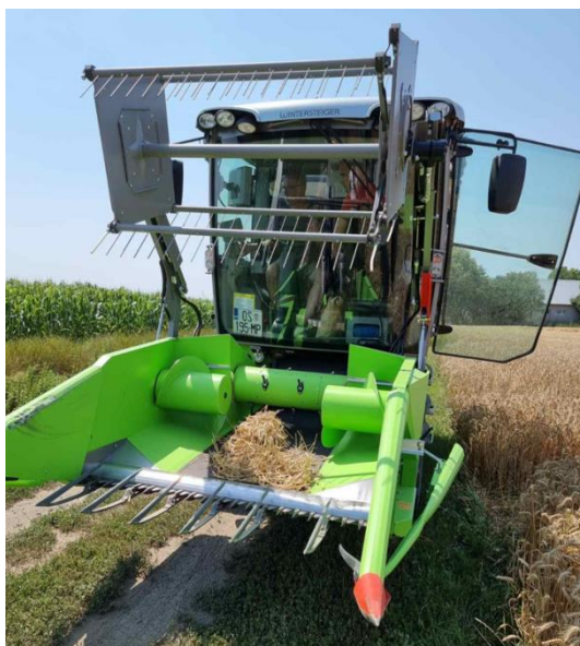
Slika 7. Specijalizirani žitni kombajn (izvor: Iljkić, D.)
