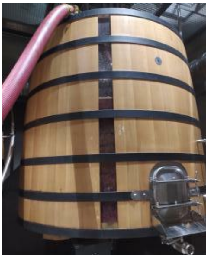
Slika 1. Punjenje masulja u vinifikator na maceraciju
