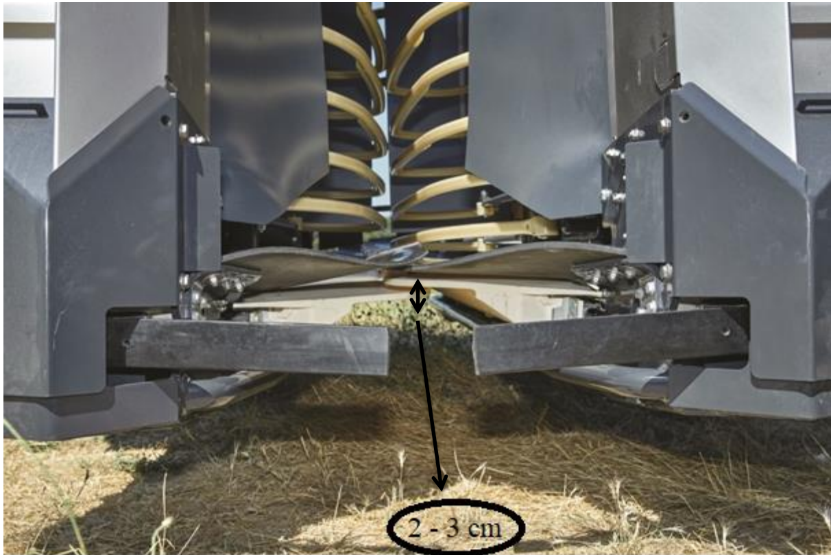
Slika 21. Pravilan razmak između letvica
