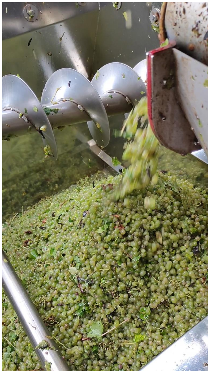
Slika 31. Transport iz ruljače u spremnik kombajna
