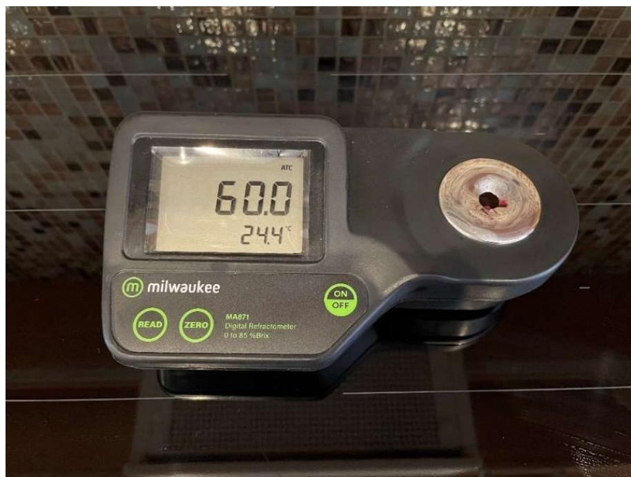
Slika 2. Mjerenje količine šećera refraktometrom (vlastiti izvor)
