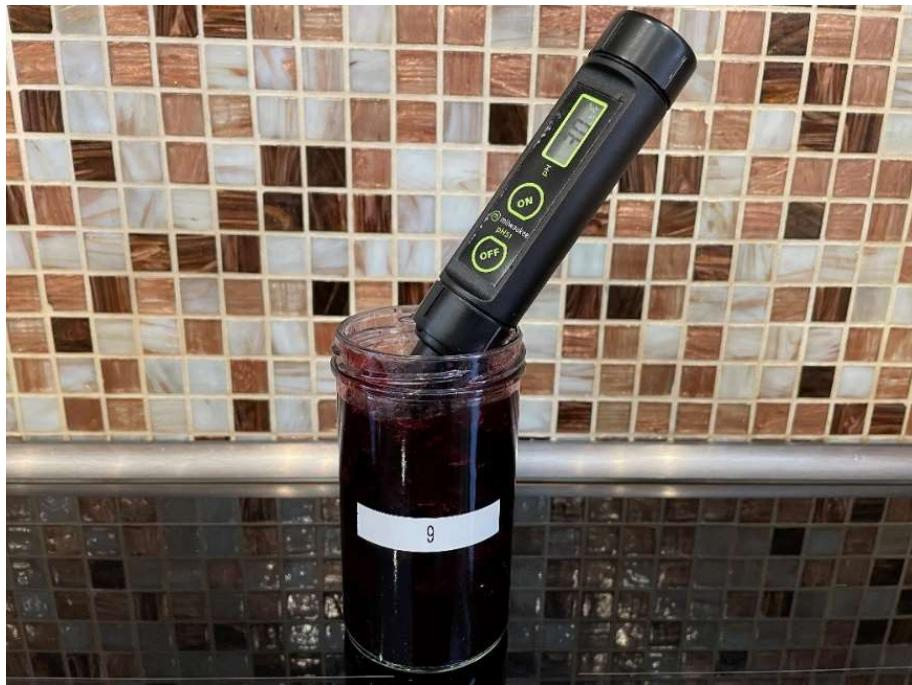
Slika 3. Mjerenje pH vrijednosti pH-metrom (vlastiti izvor)
