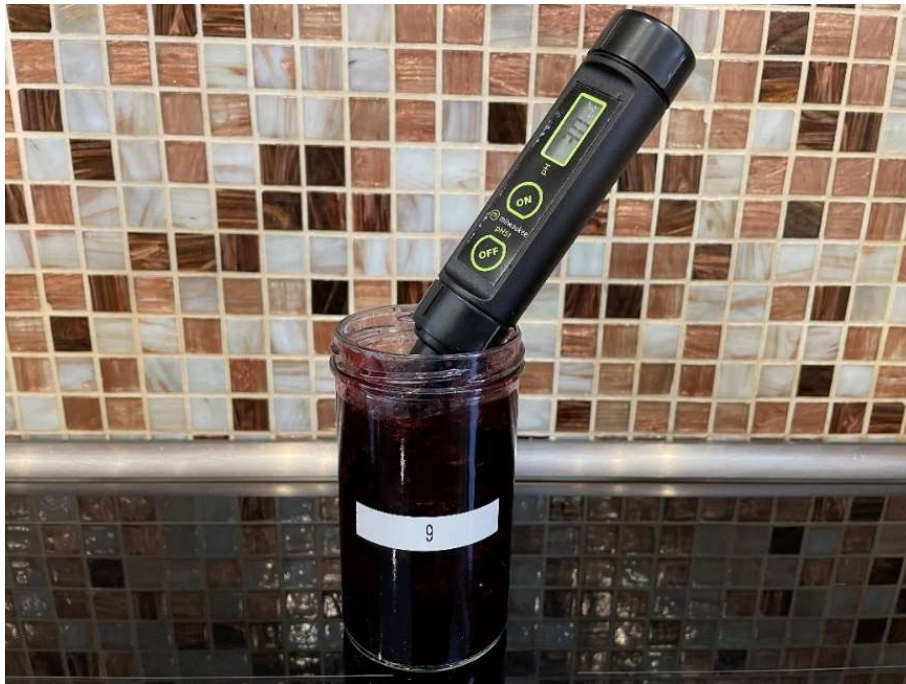
Slika 3. Mjerenje pH vrijednosti pH-metrom (vlastiti izvor)
