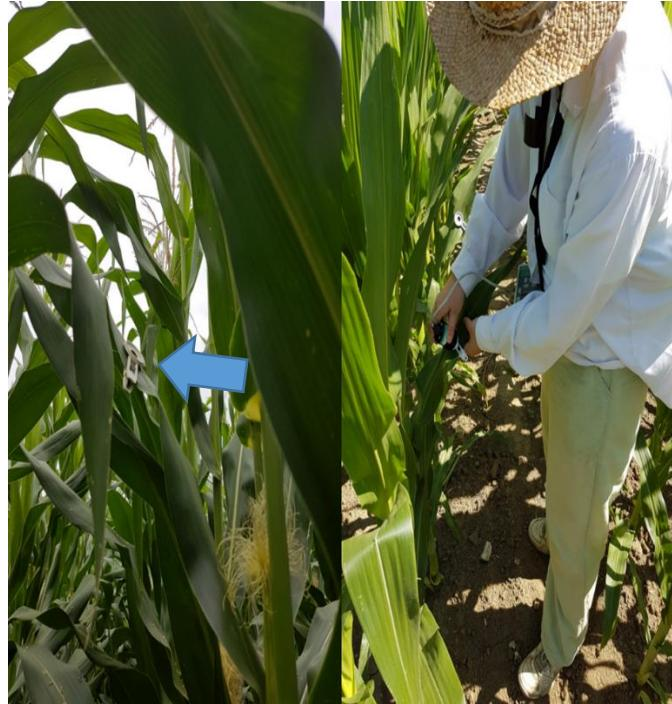
*Slika 2. Štipaljka za adaptaciju na tamu na listu na klipu cvatuće biljke kukuruza (lijevo) i mjerjenje fluorescencije klorofila a u polju ručnim fluorometrom (desno) (foto: Vlatko Galić).*
