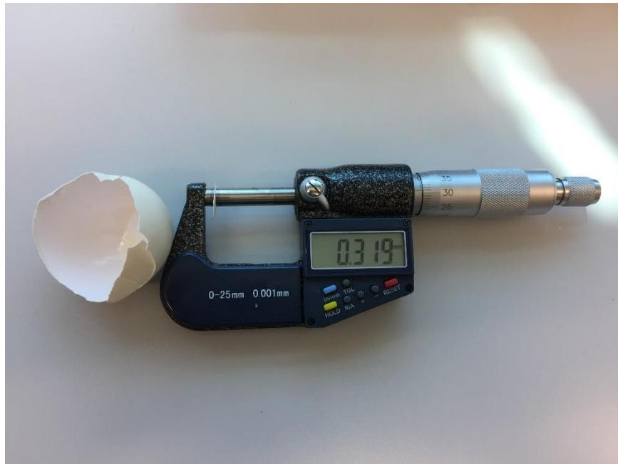
*Slika 10. Mjerenje debljine ljske jaja uporabom elektronskog mikrometra Insize, USA
