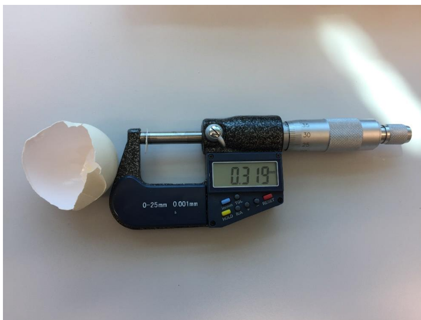
Slika 10. Mjerenje debljine ljuske jaja uporabom elektronskog mikrometra Insize, USA (Z. Kralik, 2019.)
