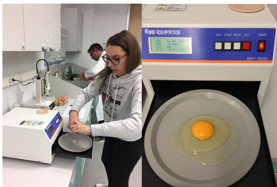
Slika 8. Egg Multi-Tester uređaj za analizu unutarnje kvalitete jaja (Z. Kralik, 2019.)
