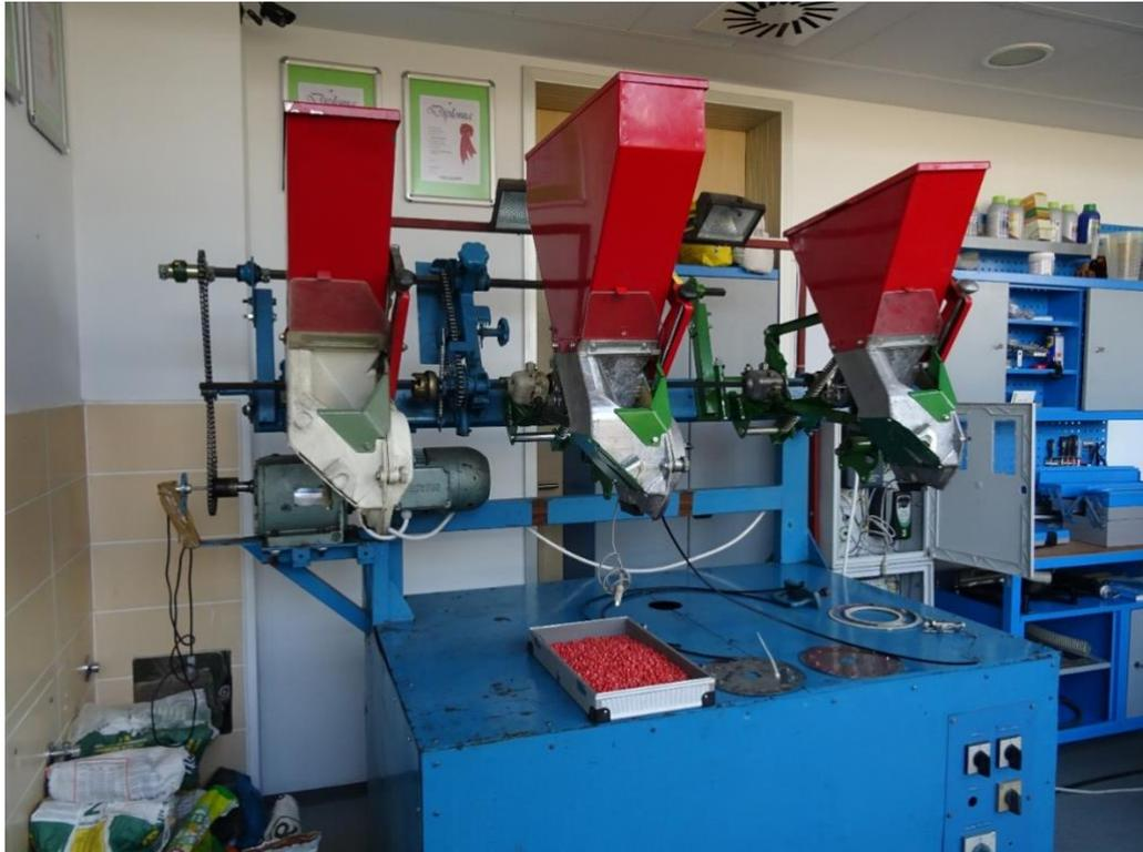
Slika 9. Ispitni stol za pneumatske sijačice
