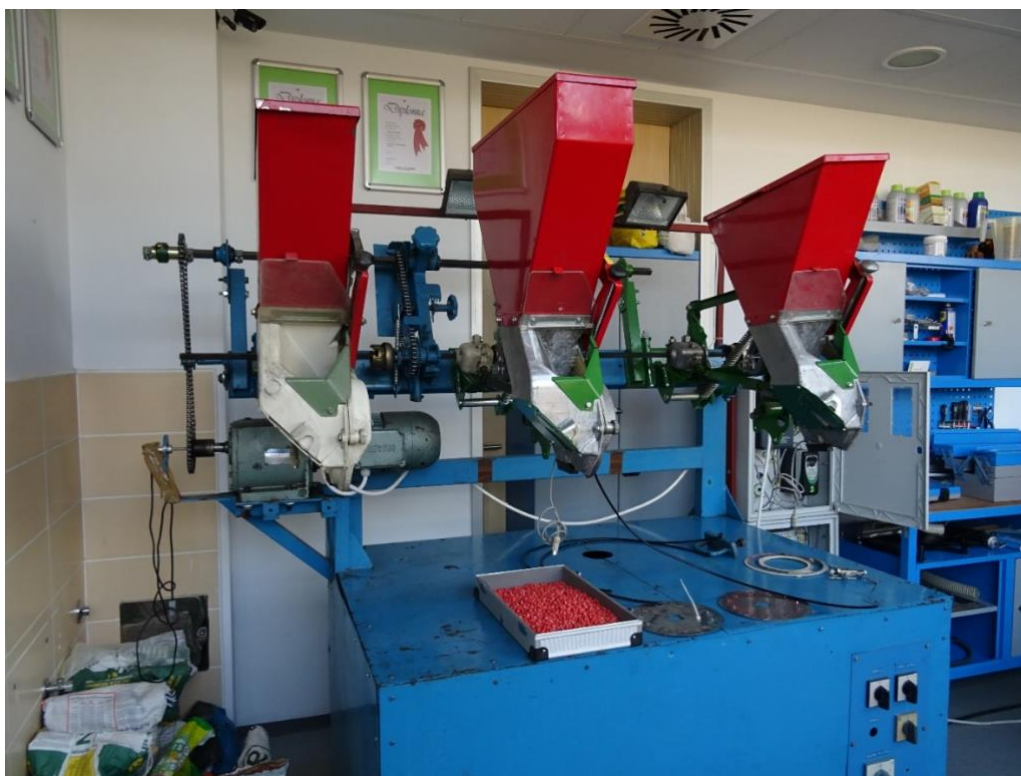
Slika 9. Ispitni stol za pneumatske sijačice (Izvor: Čalić, M.)
