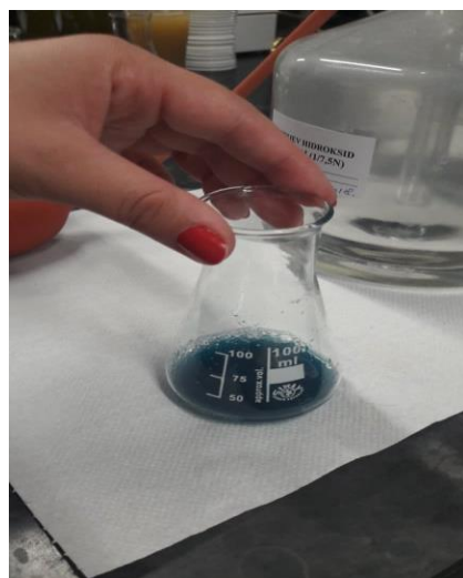
Slika 7. Titriranje s NaOH
