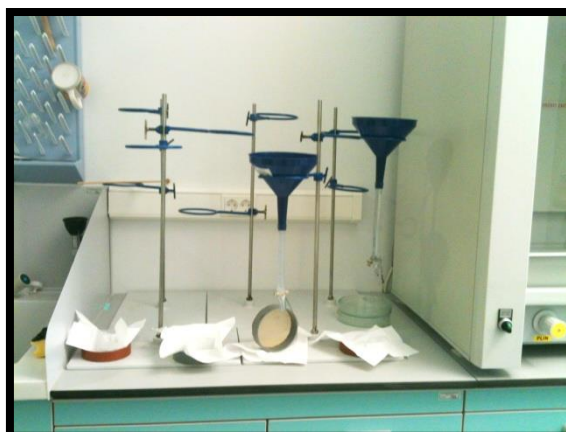
Slika 4. – „Metoda lijevaka“, Baermannova metoda izvor: Majić, I., 2013.
