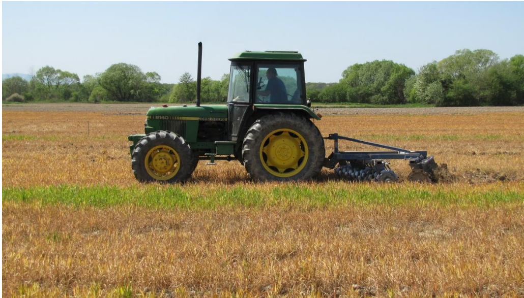
Slika 4. Varijanta obrade tla tanjuranjem
