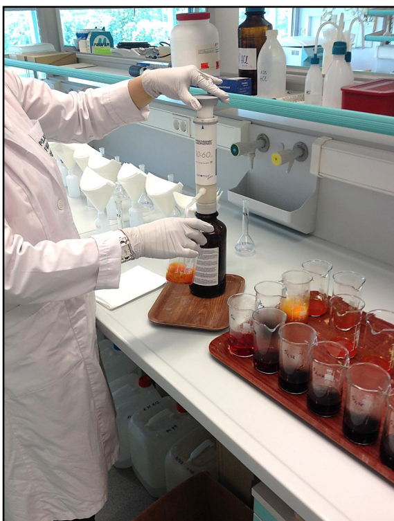
Slika 14. Dodavanje sulfatne kiseline u uzorke tla
