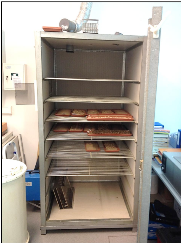
Slika 4. Sušnica za tlo i biljni materijal
