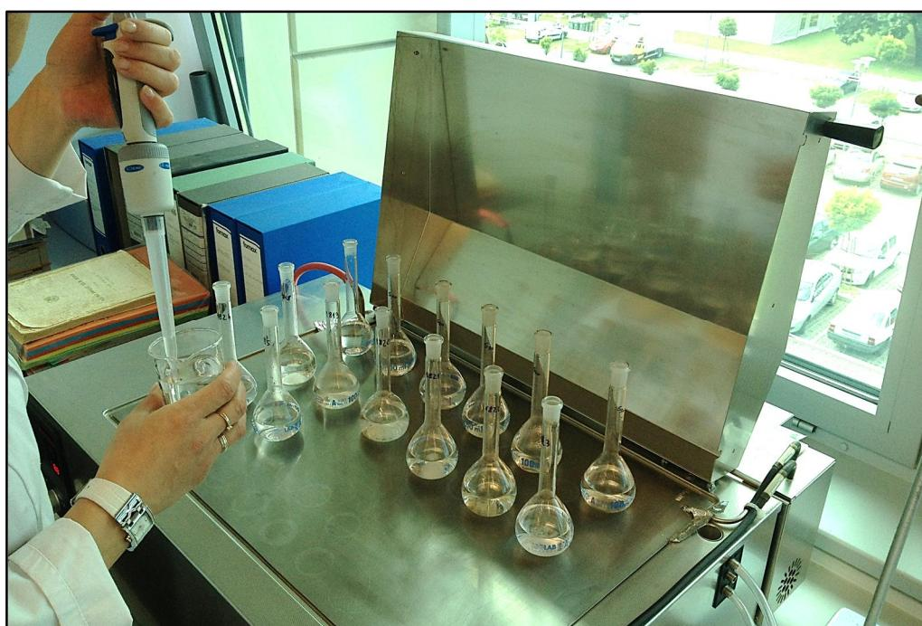
Slika 12. Priprema uzorka za određivanje fosfora (dodavanje 1,44 %-tnog amonijevog molibdata i 2,5 %-tne askorbinske kiseline)
