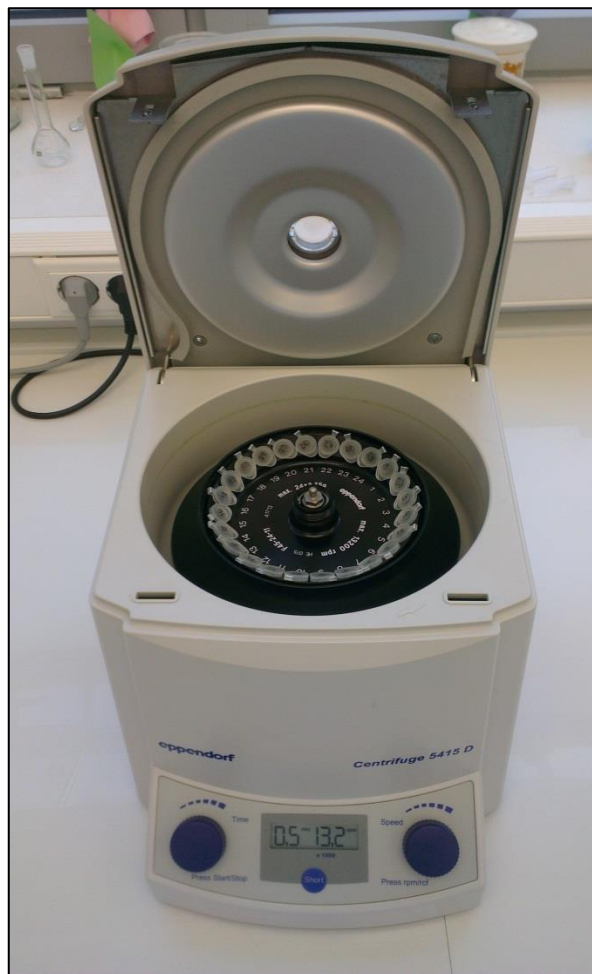
Slika 4. Centrifugiranje uzoraka (foto original; S. Guberac)
