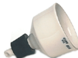
Slika 22. Büchnerov lijevak s gumenim čepom.
