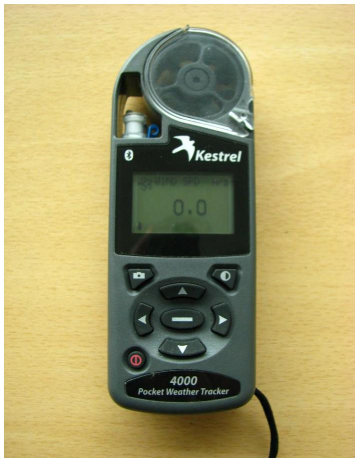
Slika 7. Anemometar *KESTREL 4000*
