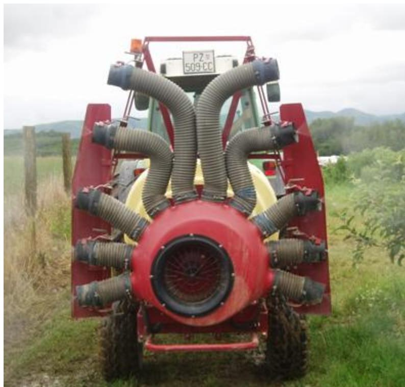
Slika 2. Radijalni ventilator
