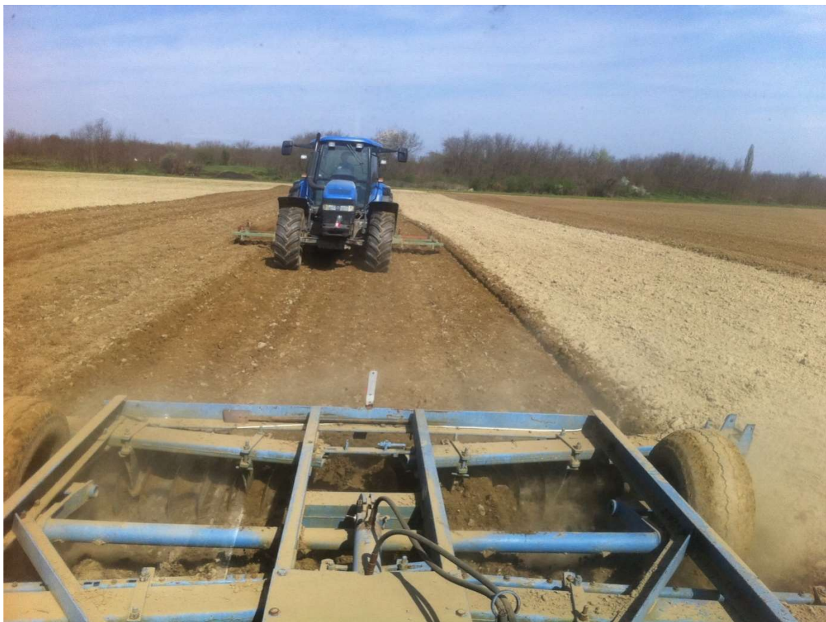
Slika 1. Traktor NEW HOLLAND TM 155 u pripremi tla za pšenicu
