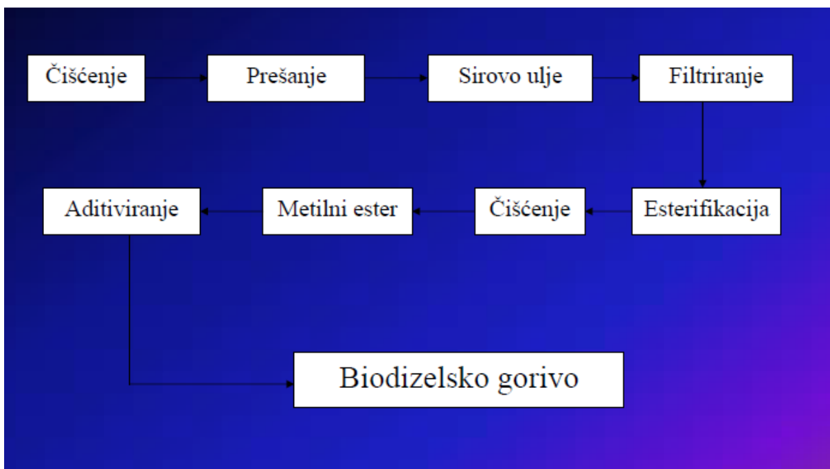
Slika 7: Redosljed procesa proizvodnje biodizela od ulja uljarica
