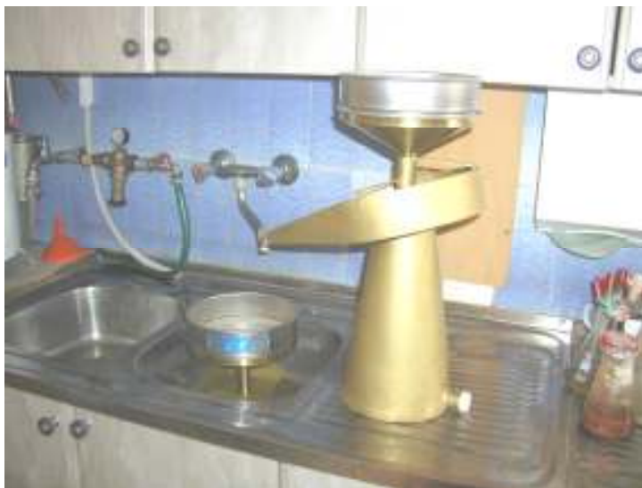
Slika 1. Fenwickov aparat za izdvajanje cistolikih nematoda (Foto: Magdika, 2004.)
