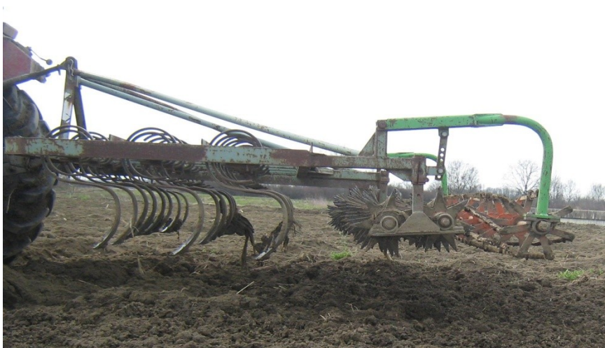
Slika 4. Prikaz sjetvospremača (foto: Z. Gugić, 2015.)
