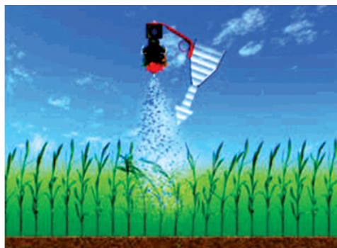
Slika 4. Kretanje kapljica sa zračnom potporom
