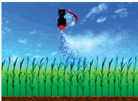
Slika 3. Kretanje kapljica bez zračne potpore
