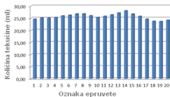
Grafikon 2. Preklapanje mlazova pri radnom tlaku 2 bar i radnoj visini 50 cm
