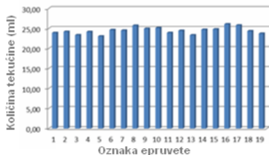
Grafikon 1. Preklapanje mlazova pri radnom tlaku 2 bar i radnoj visini 40 cm
