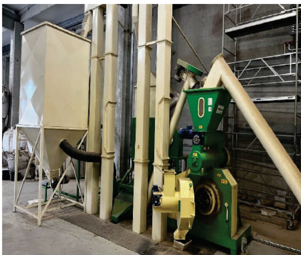
Slika 5. Preša i spremnik za agropelete (Izvor: autori)
