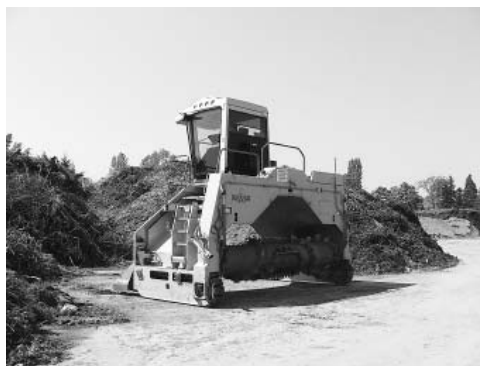
Slika 2. Strojevi za okretanje kompostne hrpe (foto: M. Stojnović i M. Vukobratović)
