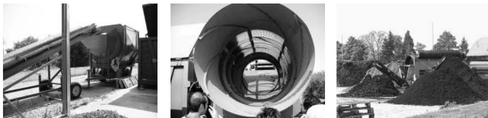
Slika 4. Separator za kompost (foto: M. Stojnović i M. Vukobratović)
