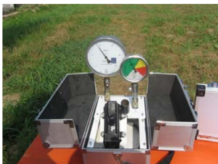
Slika 2. Komparator tlaka Volos
