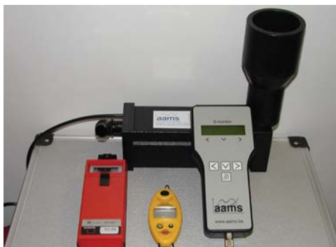
Slika 3. Uređaji za mjerenje protoka mlaznica
