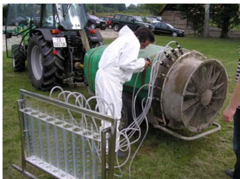
Slika 3. Uređaji za mjerenje protoka mlaznica
