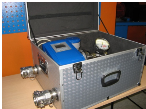
Slika 1. Elektromagnetni mjerča kapaciteta crpke tvrtke Krohne
