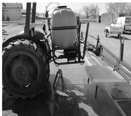
Slika 5. Ispitivanje poprečne raspodjele tekućine kod ratarske prskalice
